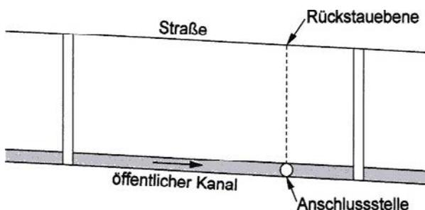
**Ausnahme:** Verläuft das StraÙengefällc gegenläufig zum Kanalgefällc, ist die Rückstauenebene die Höhe der Schachtoberkante des untenliegenden Schachtes.
